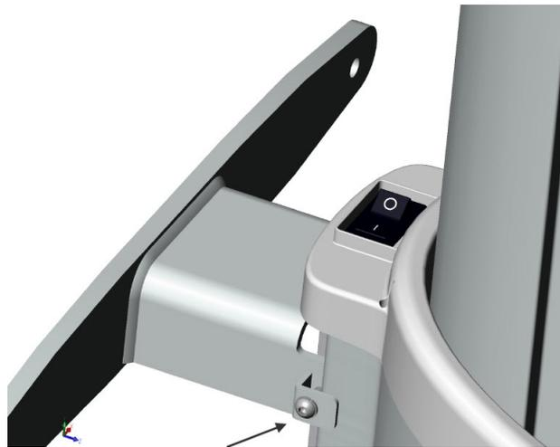
3. Einen Winkel senkrecht an die Säule halten und das Vantage-Panoramagerät auf dem Boden verschieben, bis es lotrecht steht.
