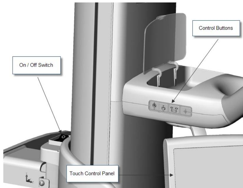
Beim Einschalten des Vantage-Panoramageräts wird ein Begrüßungsbildschirm auf dem Bedienfeld angezeigt. Im Rahmen des Einschaltvorgangs durchläuft das Vantage-Panoramagerät einen Selbsttest.
