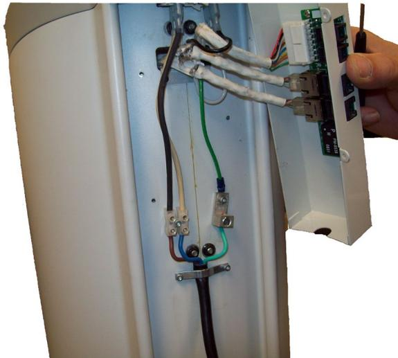
6. Die Abdeckung des Anschlusskastens wieder anbringen.
