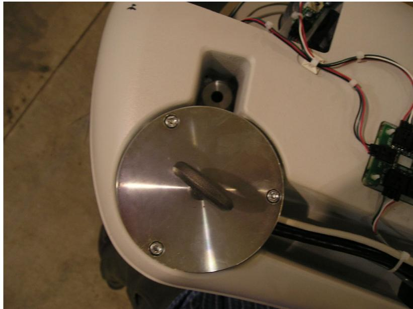
2. Die 4 Schrauben lösen, mit denen die Aluminium-Transportsicherung befestigt ist (siehe nachstehende Abbildung).
